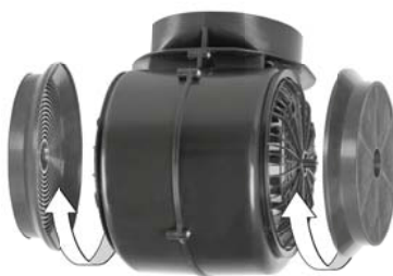
Montaż filtrów węglowych do turbiny
